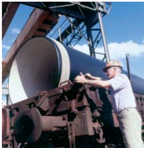
Vérification du calage lors du chargement de tuyaux grand diamètre.
