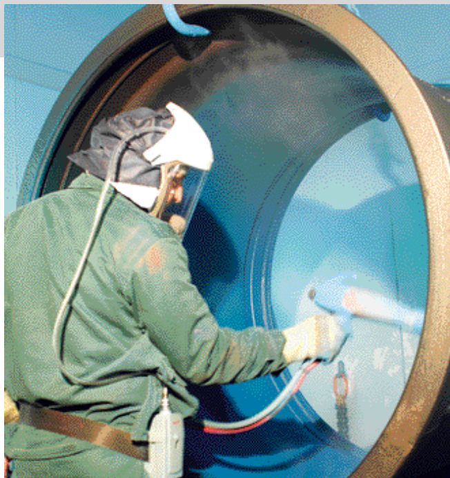
Revêtement de canalisation en fonte ductile de grand diamètre.
