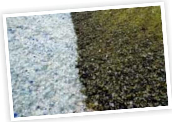
**Le calcin**, verre brisé, est utilisé pour la fabrication de nouveaux produits.
