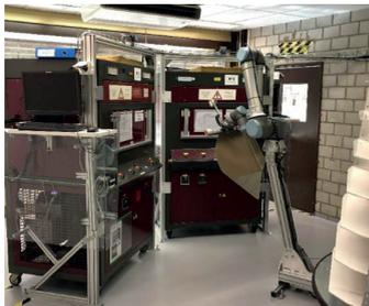
Depuis plusieurs semaines, un cobot a fait son entrée sur le site ISOVER de Lucens en Suisse. **Les cobots (« robot collaboratif ») sont des bras robotisés et articulés qui se distinguent par leur capacité à interagir et coopérer avec l'être humain.**
