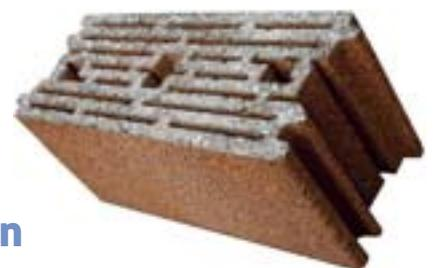
Eurobéton Industrie (Distribution Bâtiment) a développé Calimur C20, un nouveau bloc en argile expansée. Ses performances d'isolation, cinq fois supérieures à celles d'un bloc de béton classique, permettent de construire des murs porteurs Bâtiment basse consommation. Sa pose collée améliore la propreté des chantiers et la rapidité d'installation.
