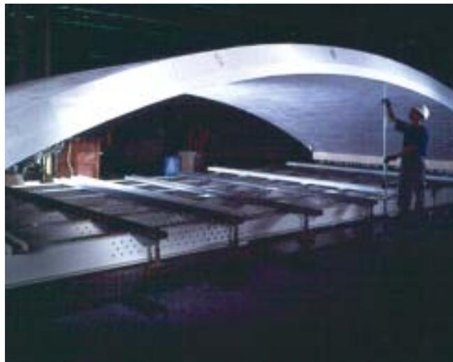
*Voûte en matériaux électrofondus, conçue pour un four verrier.*
