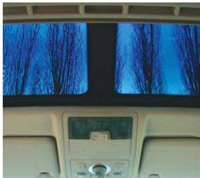
Nouvelle technologie permettant de régler la teinte du vitrage automobile.
